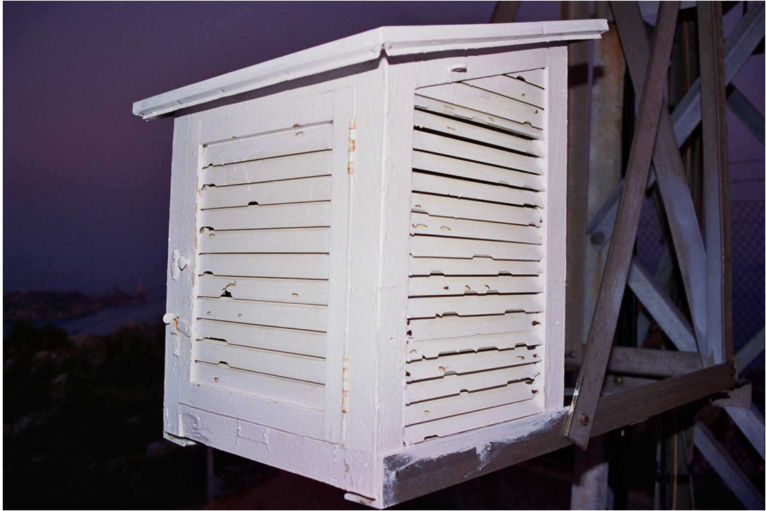
La gàbia meteorològica de Roca Maura, amb evidents marques de la pedregada.
